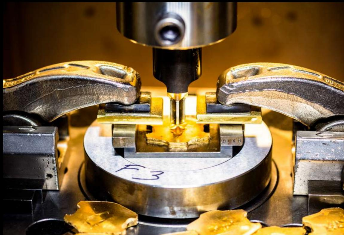
Dans les ateliers suisses de PX Precinox, spécialiste du traitement des métaux précieux, l'or purifié par électrolyse et réduit à l'état de microbilles (à gauche) est prêt à être fondu puis préusiné en vue de façonner des cadrans de montres. La Suisse est la principale plaque tournante mondiale du marché de l'or.
